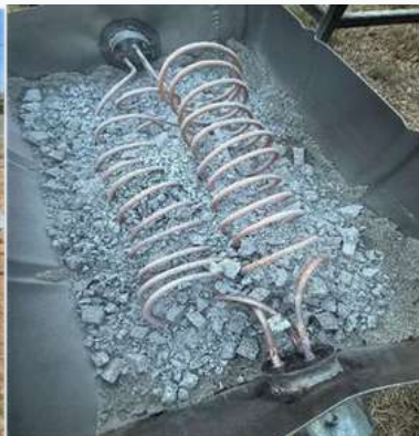
Fabricación del sistema de almacenamiento de calor (TES) con granito y arena como materiales para almacenamiento de calor sensible.
