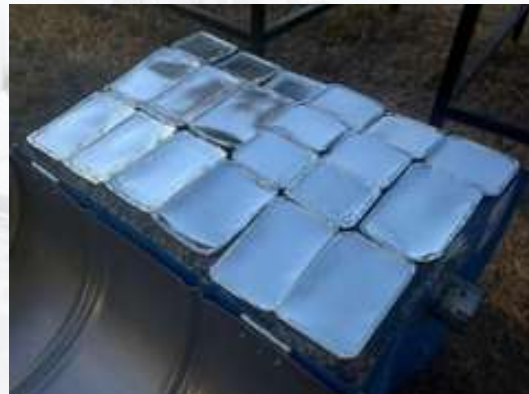
Fabricación del sistema de almacenamiento de calor (TES) con granito y arena como materiales para almacenamiento de calor sensible.
